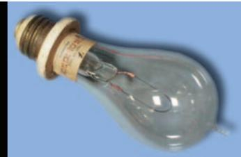
Le gain d'efficacité dans la production de lumière est un exemple de l'évolution technique. En 1879, l'ampoule d'Edison produisait un flux lumineux de 3 lumens par watt de puissance électrique consommée. Aujourd'hui, la lampe fluorescente et les éléments LED (grande image) produisent 100 lumens par watt.
